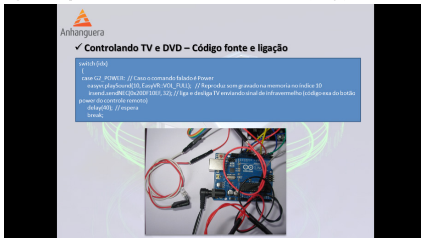
Figura 12: Apresenta a funcionalidade de acionamento da TV (código)
