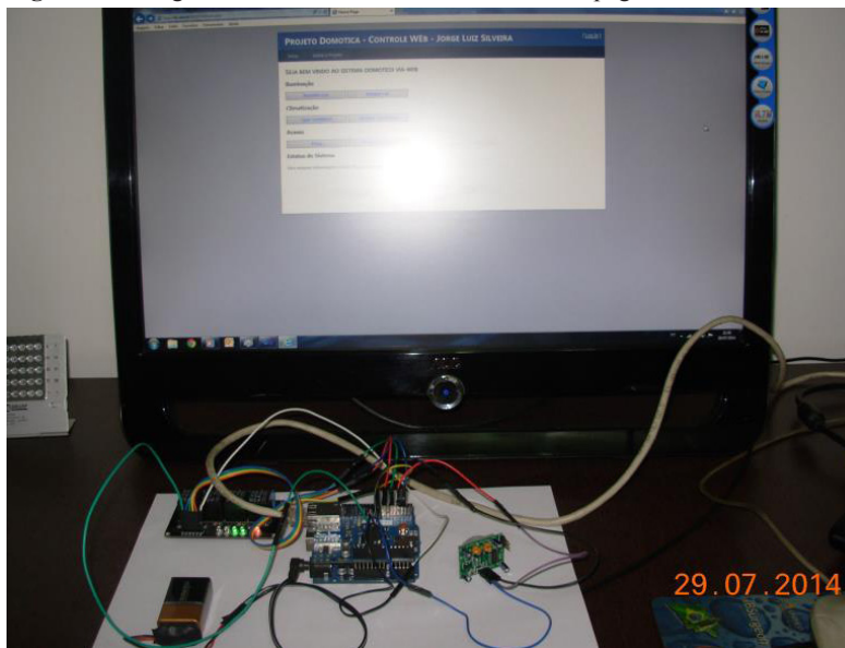
Figura 14: Imagem do teste de acionamento através da página web
