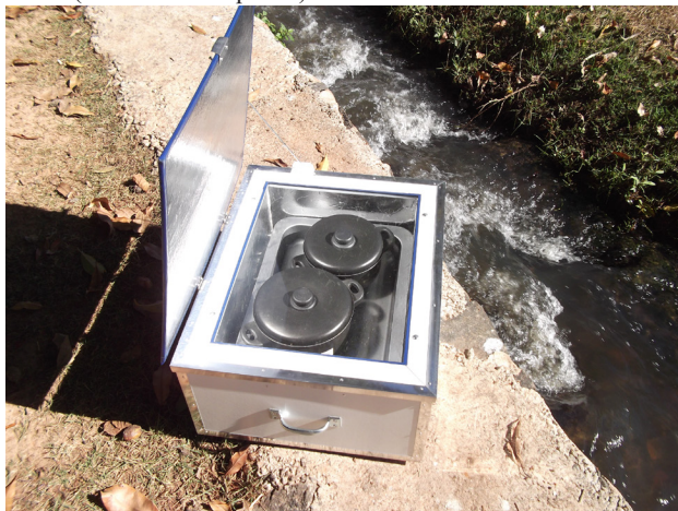
Figura 4 - Forno solar do tipo coletor de placa plana com uso direto (modelo caixa quente)
