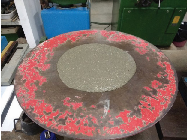
Figura 5 - Realização do ensaio de consistência na mesa de abatimento
