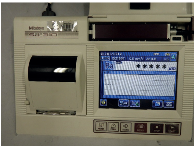
Figura 4 – Rugosímetro utilizado nas medições de Rugosidade Média.
