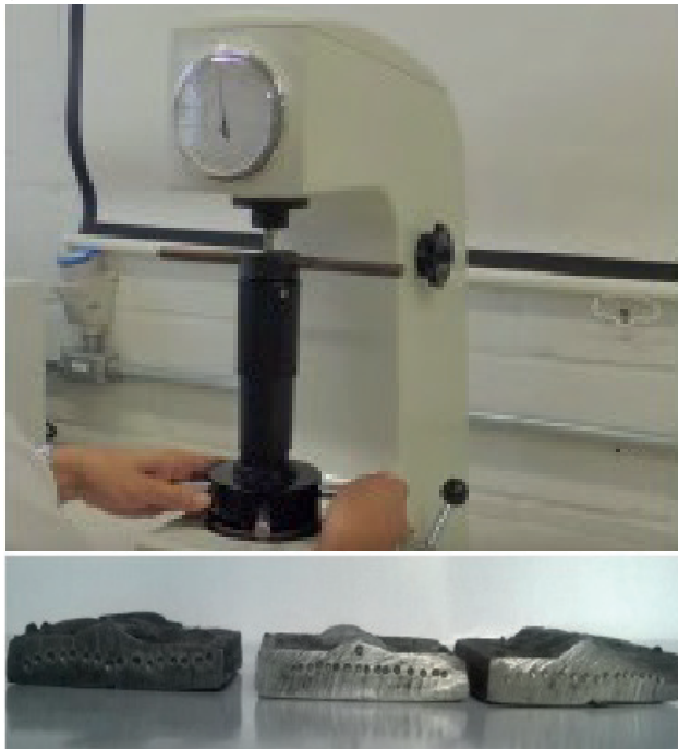
Figura 4 - Durômetro utilizado (esquerda) e CP's ensaiados (direita)
