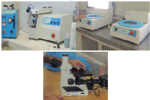
Figura 6 - Da esquerda para direita: Embutidora, Cortadora, Lixadeira, Politriz e Microscópio
