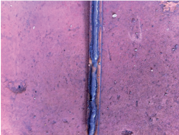
Figura 3 - Tiras de aço soldadas para realização dos ensaios
