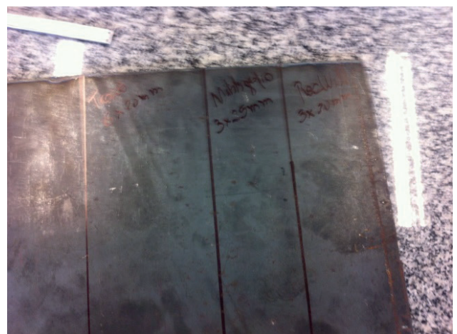
Figura 2 - Chapa de aço com os tamanhos das tiras pré-determinados
