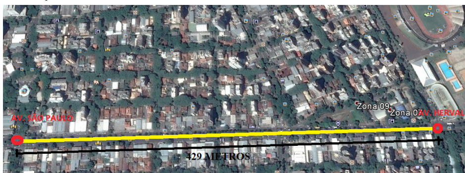
Figura 5: Trecho da Avenida Colombo, localizado entre as Avenidas São Paulo e Demétrio Ribeiro, com comprimento de 429 metros e declividade de 2,5%
