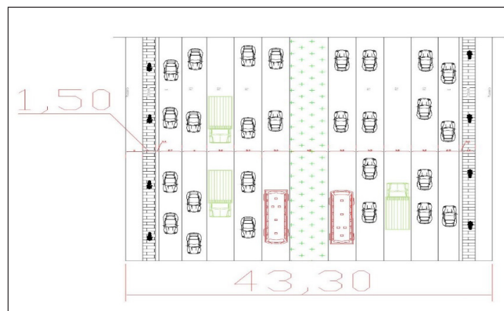
Figura 7: Imagem em planta baixa da Avenida Colombo com implantação de ciclovia
