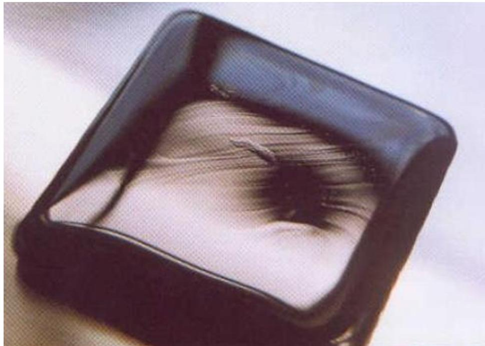
Figura 7 – Vidro negro produzido a partir de escória de alto forno.
