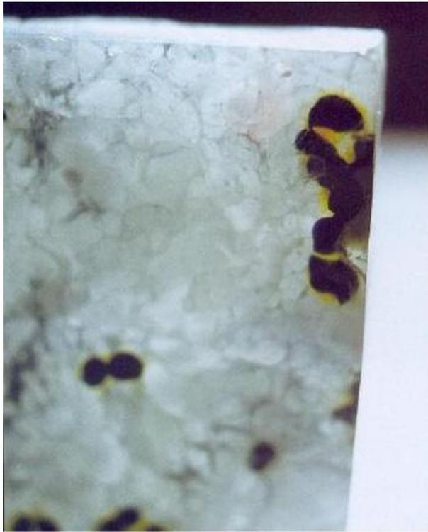
Figura 6 – Peça de vitrocerâmica que poderá concorrer no mercado com o mármore.
