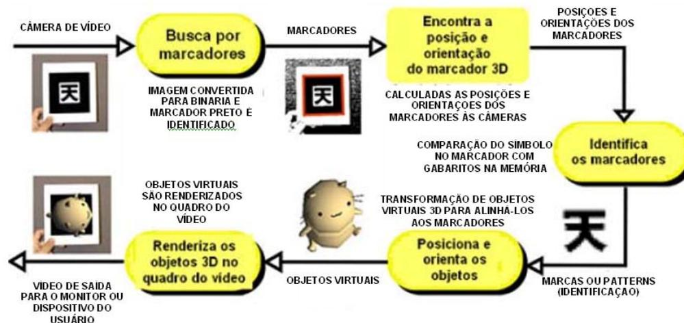
Figura 4 – Diagrama dos passos da detecção dos marcadores e posicionamento de objetos virtuais sobre os marcadores na cena do mundo virtual (CALONEJO JR., 2004).
