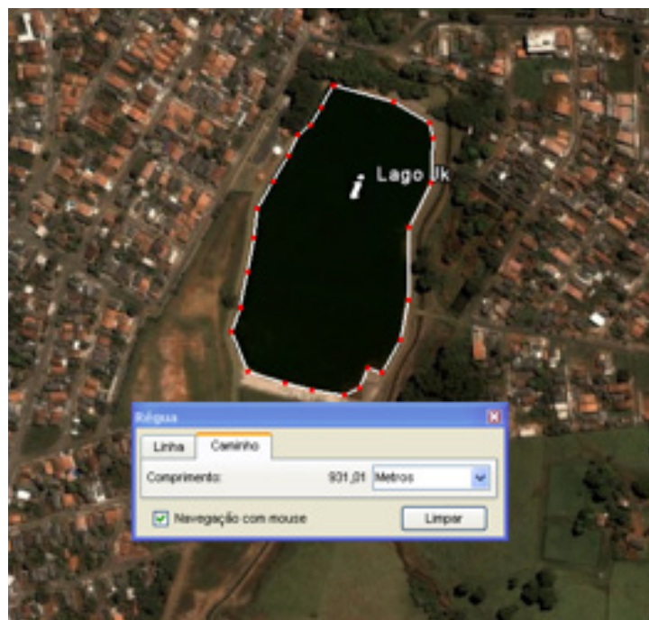
Figura 7: Utilização da ferramenta régua do Google Earth para medição da extensão do Lago JK
