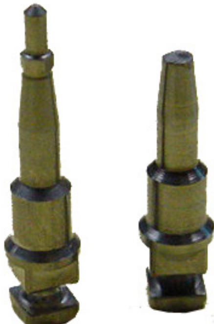
Figura 5 – Representação dos implantes sem e com fratura (ponto de ruptura).
