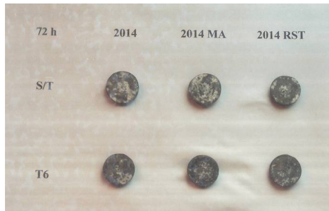
Figura 4 – Aspecto das amostras após 72 horas de imersão na solução padronizada para o ensaio ASTM G34. (Microscopia ótica).
