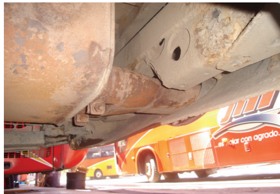
Figura 6 – Corrosão da ligação com chassis
