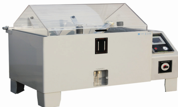
Figura 10: Máquina de teste da corrosão do pulverizador de sal
