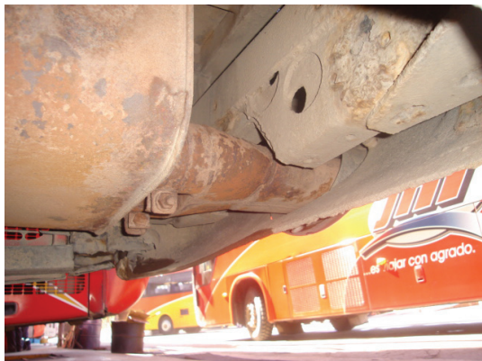
Figura 5 – Corrosão do escapamento
